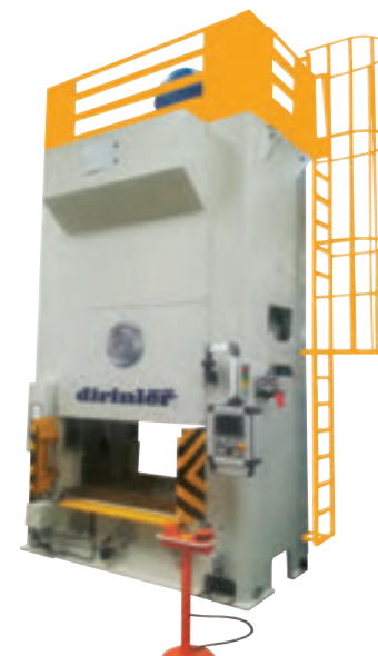
Н-образный Эксцентриковый Пресс с одним шатуном
